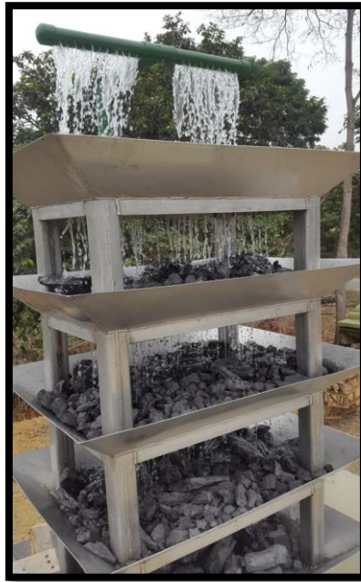
Figura 3. Torre de oxidación
