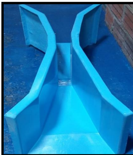
Figura 5. Canaleta Parshall
